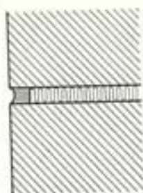
Fig. 2.24. Fuge med 1-trins tætning.
