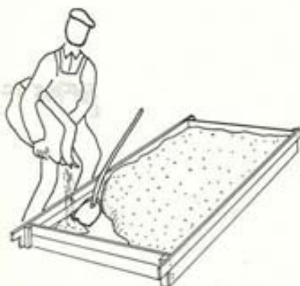
Fig. 6.14. Forkastelig fremgangsmåde ved blanding af K-mørtel og cement.
