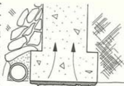
Fig. 2.27. Frosthævning, som skyldes islinser under fundamentfoden.
