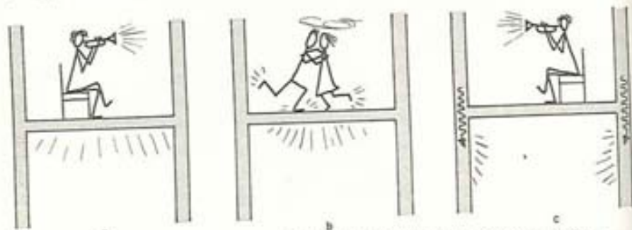
Fig. 2.37. Lydoverføring ved a: luftlyd, b: trinlyd, c: flanketransmission.
