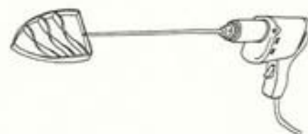
Fig. 6.16. Blandevinge anbragt i elektrisk håndboremaskine.
