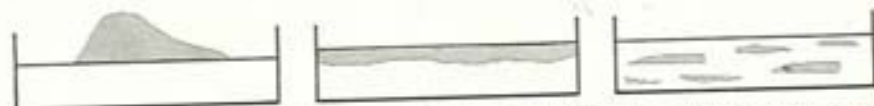
Fig. 6.15. Demonstration af mangelfuld cementfordeling i sand eller K-mørtel ved blanding med skovl.
