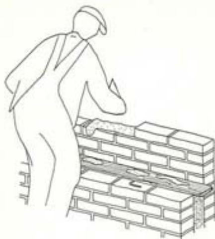
Fig. 8.06. Muring med brædt på trådbinderne.
