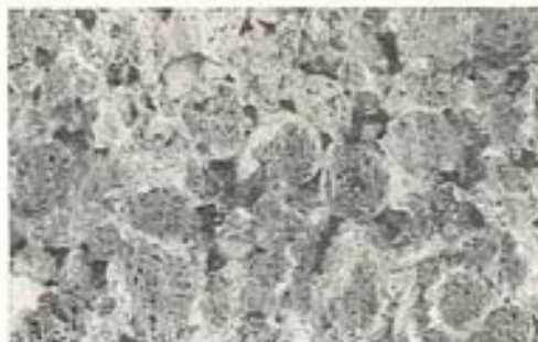
Fig. 2.06. Snit gennem klinkerbeton med opblærede teglklunker (ca. 1:1).
