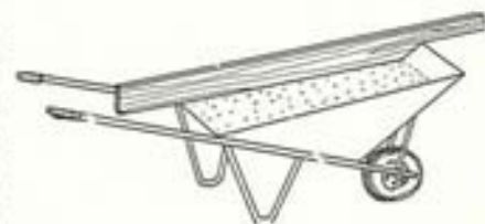
Fig. 6.13. Trillebør med afstryger (ko) til brug ved rumfangsmåling.
