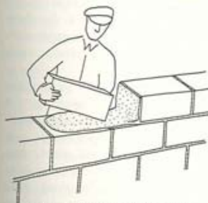
Fig. 8.23. Muring med blokke i 2-hånds format.
