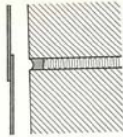
Fig. 2.25. Fuge med 2-trins tætning.
